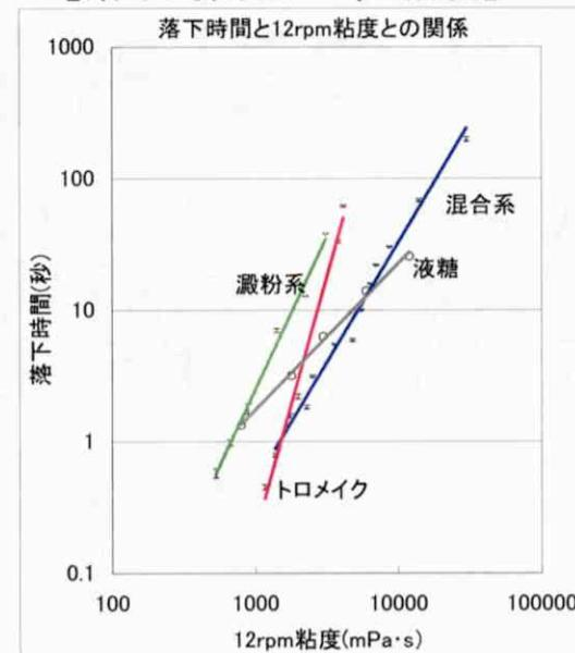
3種類のトロミ調整食品と液糖の測定データを合わせて両対数のグラフにプロットした。
